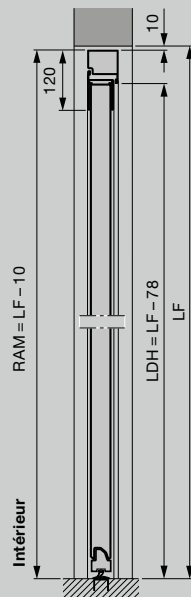
Portillon indépendant avec huisserie tubulaire en aluminium, type de profilé 2 Pose dans la baie
